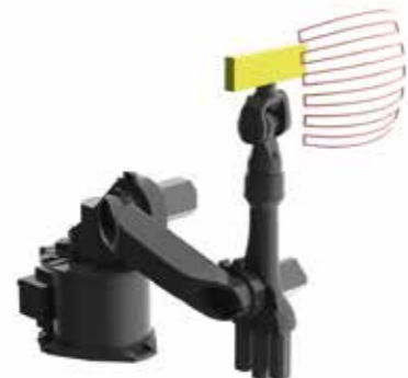
robogonio: Goniophotometer Typ 1.1, A-Ebenen
