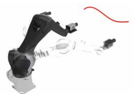
robogonio: Abrastern einer Geometrie im Raum
